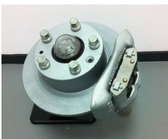
Scheibenbremsen mit 100% wasserdichte Öl gefüllten Radlager
