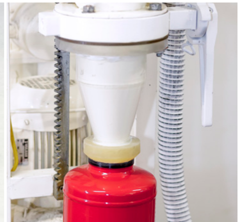
6 Befüllung des Löschmittelbehälters 4 Min
