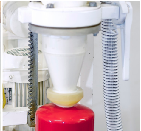
6 Befüllung des Löschmittelbehälters 4 Min
