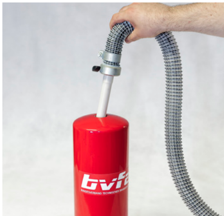
5 Entleerung des Behälters und Löschmittelkontrolle (Volumen, Menge, Zustand) 2 Min
