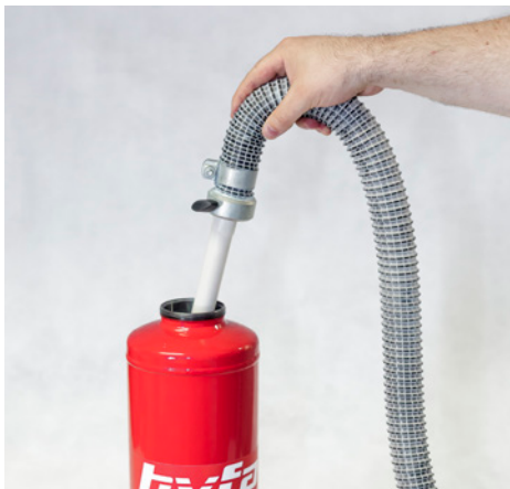
4 Entleerung des Behälters und Löschmittelkontrolle (Volumen, Menge, Zustand) 2 Min
